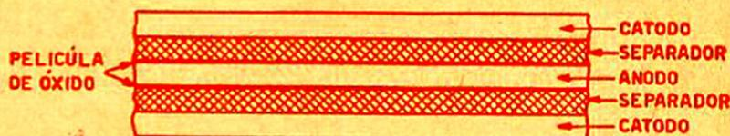
Fig. 3 - Corte através das armaduras de um condensador eletrolítico seco. O separador contém o eletrólito.
